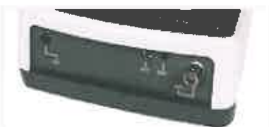
Ingressi alimentazione, elettrodo e riferimento
