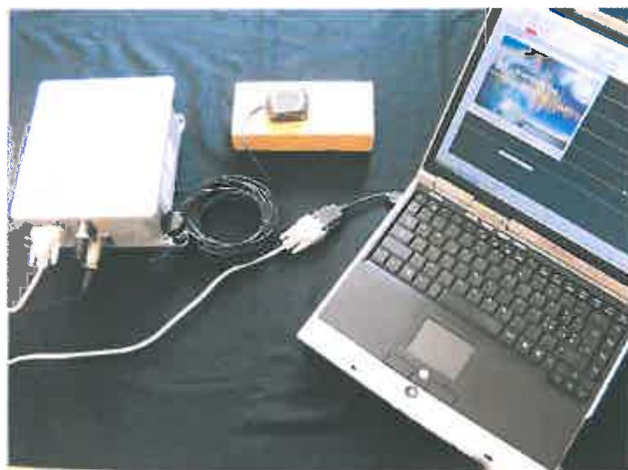
Fig. 1: collegamento della stazione al computer *
