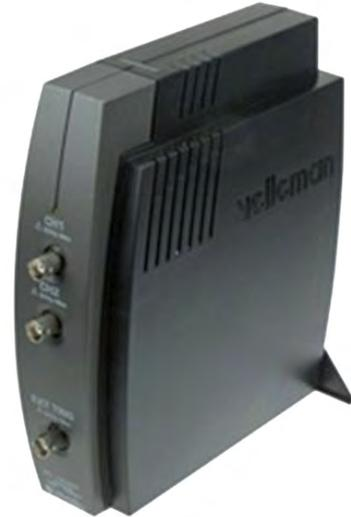
El osciloscopio digital mod. IU11-A/EV utiliza la capacidad de cálculo del PC para visualizar las señales eléctricas. Presenta una elevada resolución gráfica hasta 0,15 mV, una gran banda pasante y una frecuencia de muestreo hasta 1GHZ.
