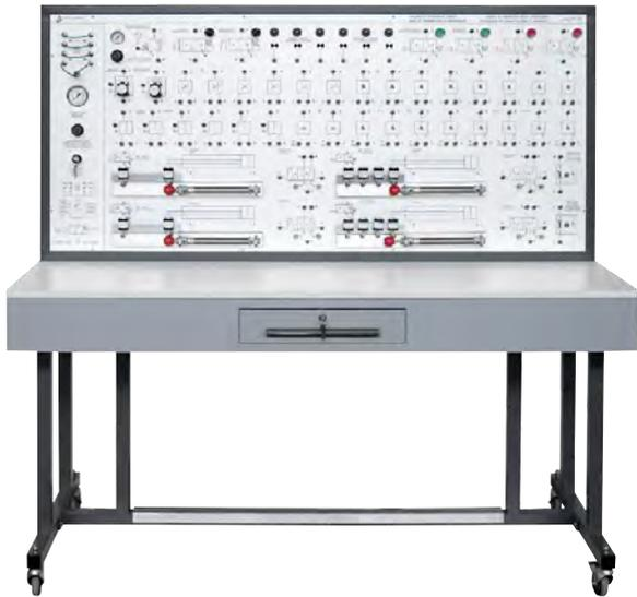
Ce banc permet au professeur de développer un programme intensif sur les techniques de la commande pneumatique et de la logique pneumatique. Il constitue, en effet, un support flexible d'exécution et de démonstration des circuits pneumatiques et prévoit la réalisation de nombreux cycles séquentiels industriels suivant différentes techniques normalisées.
