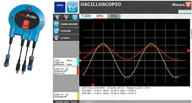
Cette unité d'interface permet la liaison sans fils avec l'outil de diagnostic afin de visualiser et de gérer les mesures électriques avec les fonctions multimètre et oscilloscope 2 canaux.
